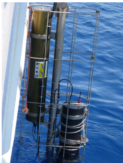
Рис. 5. Извлечение спектрометра после глубоководной долговременной миссии
